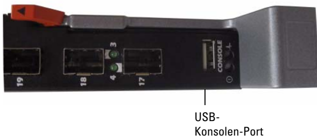
Abbildung 1-4. PowerConnect M8024-k USB-Konsolen-Port
