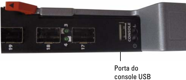
Figura 1-4. Porta do console USB do PowerConnect M8024-k
