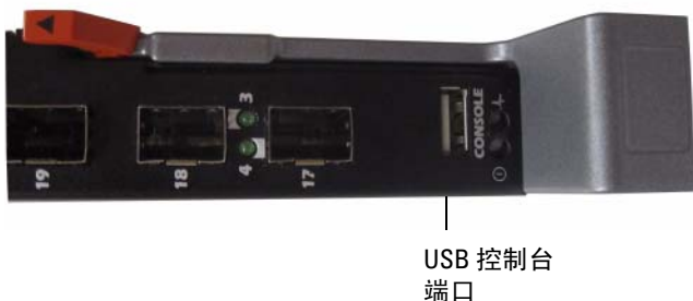
图 1-4. PowerConnect M8024-k USB 控制台端口
